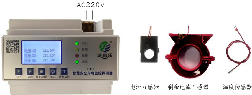
图 3-1 XHG1299 4G 智慧安全用电探测器组成
